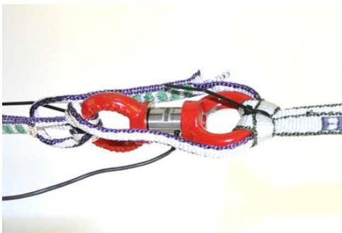
Abbildung 1: Kraftmesssensor mit redundanten Dyneema-Schlingen
